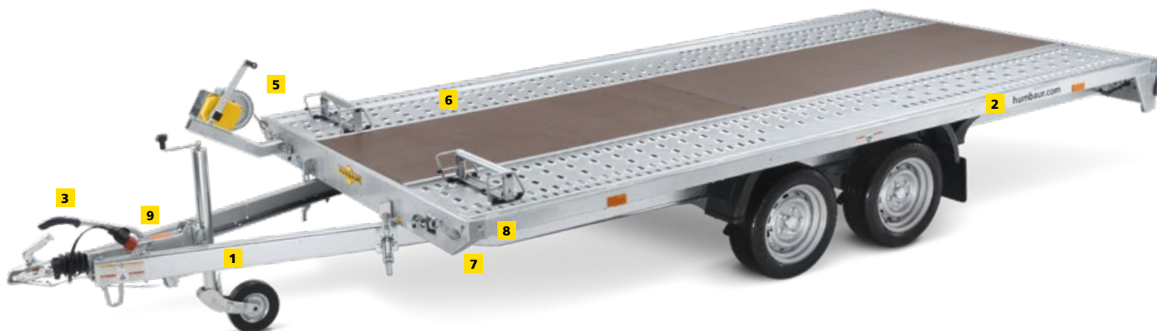
Besondere Stabilität durch quergerichtete Profilein der Brücke
