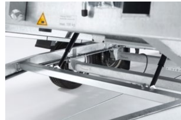
Brücke mit speziellem Kipp-lager
