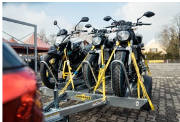
3 Standschienen mit Bügel montiert
