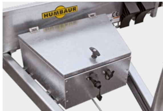
Deichselbox zum Schutz der Batterie und der Absenkhdraulik
