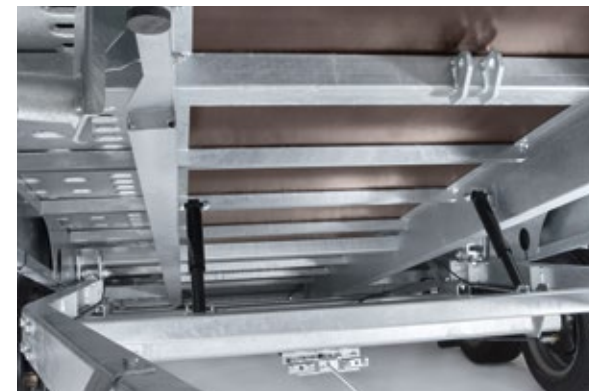
Extreme Stabilität durch eine geboltzte, genietete und verschraubte Brücke mit durchgehenden Brückenlängsträgern
