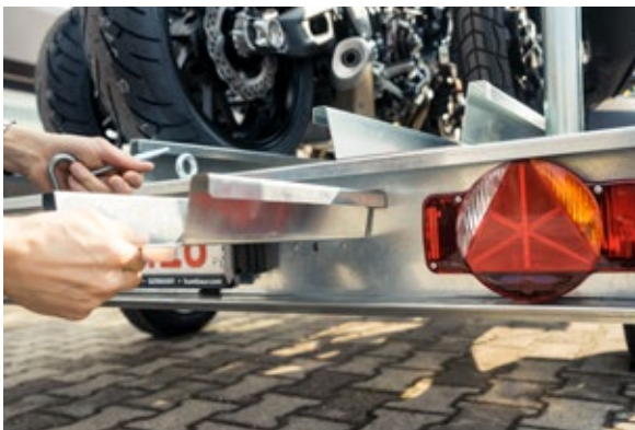
1 Auffahrschiene im Bohlenschacht integriert
